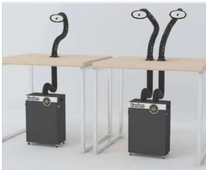
烟雾净化器是一种针对工业废气烟尘、烟雾而设计的空气净化器，结构由吸尘管道、过滤器、活性炭过滤器、吸尘风机及触摸式微电脑控制器等组成的一个完整的空气净化系统。烟雾净化器通过风机引力作用，将生产中产生的废气经进气口吸入设备，废气经过设备内的预过滤层、主过滤层、气体滤层等逐级净化，通过净化后的气体可重新排放到室内。其中设备内的预过滤层能够吸附废气中比较大的粒子；主过滤层由HEPA过滤芯组成，对直径 $\mu$ 米的颗粒有效；气体过滤层由化学滤芯组成，能净化废气中的有害气体 $\text{NO}_x$ 、 $\text{SO}_2$ 、 $\text{O}_3$ 、 $\text{VOC}$ 等。KARDERS烟雾净化器努力研发、生产多规格烟雾净化器，公司已有10年行业净化经验，产品应用于机械、五金、电子电器、光电、化工、制药、食品、生物等行业及其它有烟尘、烟雾、粉尘污染的场所，是烟雾净化器行业的佼佼者。
